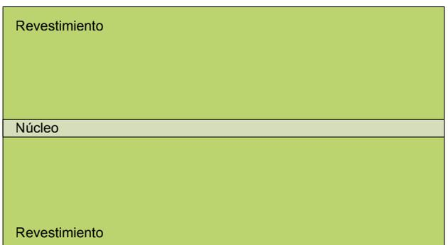
El núcleo de la fibra se compone de un núcleo y un revestimiento. Este revestimiento se protege con una capa primaria.
