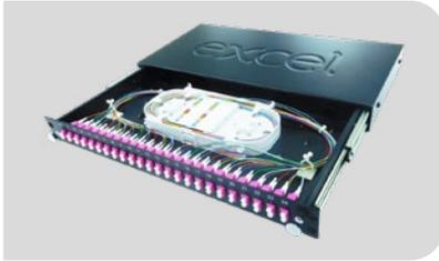
Las bandejas deslizantes para fibra son uno de los componentes principales de la mayoría de las instalaciones de fibra óptica, y se utilizan para distribuir la fibra por la red. Las bandejas para fibra deben diseñarse de forma que permitan una protección de alta calidad de la fibra entrante.
